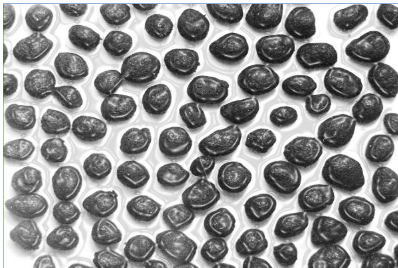
Рис. 1. Зовнішній вигляд нафтонаповнених гранул-агломератів. Середня крупність гранул – 3-5 мм.
