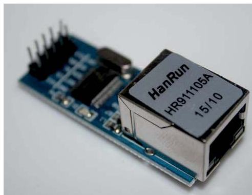
Рисунок 5 – Загальний вигляд мережевого модулю HR911105A
