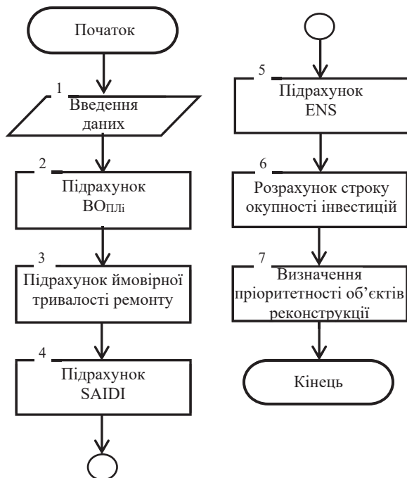
Рисунок 1 – Блок-схема алгоритму визначення пріоритетності об'єктів реконструкції розподільних мереж
