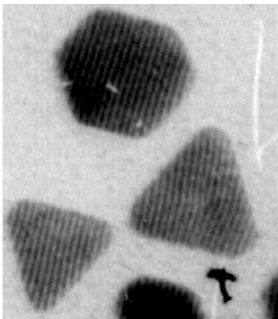
Рис. 9.6 - Виділене на рис. 9.5 кружком місце збільшене, у монокристалику золота можна спостерігати крайову дислокацію
