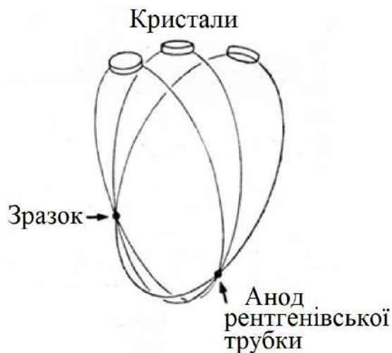
Рис. 23.16 - Умовна схема обладнання рентгенівського монохроматора із трьома колами Роуланда, використовувана для підвищення інтенсивності монохроматичного рентгенівського випромінювання.
