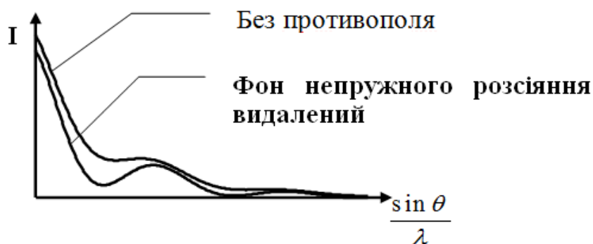
Рис. 2.10 - Інтенсивності дифракції електронів на аморфних об'єктах з використанням відфільтрованого протиполям і не відфільтрованого випромінювань
