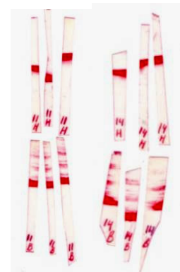
Рисунок 16 – Контактні відбитки, отримані у ході експериментальних вимірів для сили штампування P_{шт} = 1,5 кН при різних значеннях технологічного зазору між матрицею і пуансоном (заготовка товщиною 1 мм):
