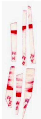
Рисунок 16 – Контактні відбитки, отримані у ході експериментальних вимірів для сили штампування P_{шт} = 1,5 кН при різних значеннях технологічного зазору між матрицею і пуансоном (заготовка товщиною 1 мм):
