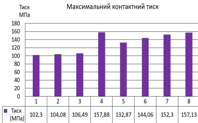
Рисунок 10 – Максимальний контактний тиск (див. табл. 1)
