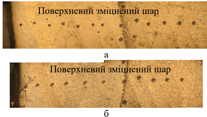
Рис. 1 – Мікроструктура сталі 65Г після ТФО та нагрівання до різних температур: а – 200 °С; б – 400 °С
