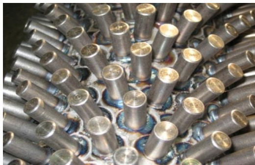
Рис.1 - Фрагмент труби (15Х5М) з навареними шипами (сталь 20)
