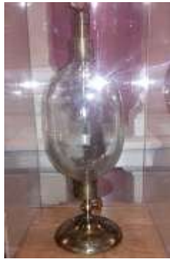
Демонстраційна лампа для вивчення електричного розряду в газі
