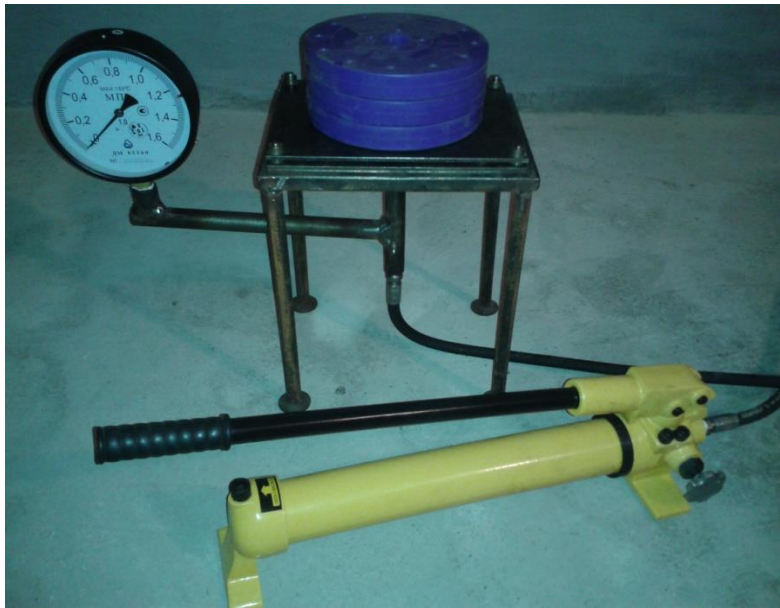
Рис. 3. Тарувальна установка: а – принципова схема установки: 1 – вантаж; 2 – гумовий зразок; 3 – опорна плита; 4 – змінна вставка; 5 – контрольний отвір; б – загальний вигляд тарувальної установки
