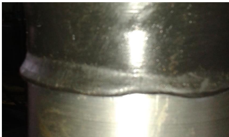
Рис. 9. Результати витискання опорної частини манжети в зазор 3 мм при вилученні пакера після дослідження із лабораторного стенду
