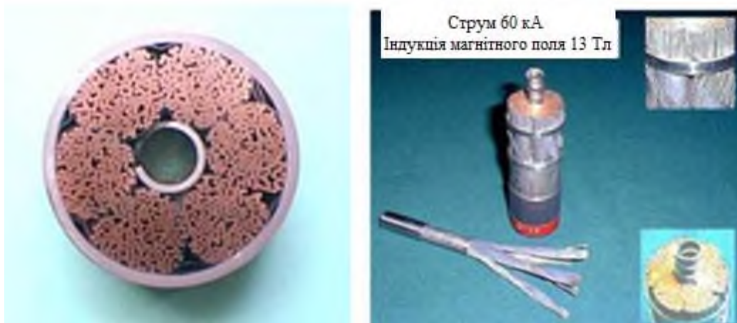
Рисунок 4 – Надпровідний кабель на основі Nb_3Sn для тороїдального магніту термоядерного реактора ITER
