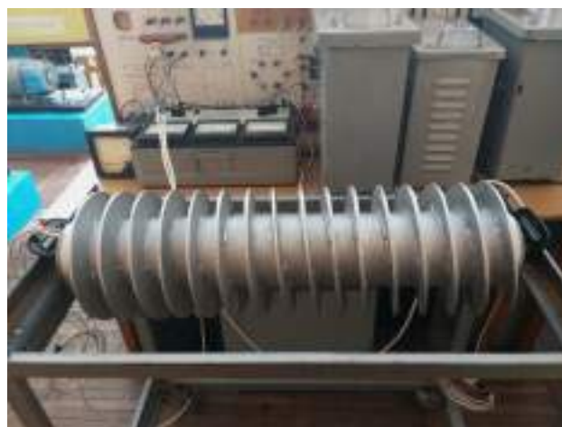
Рис. 7. Експериментальний зразок шнеку електромеханічного гідролізера
