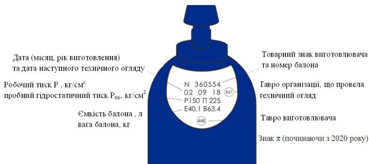
Рисунок 2 – Схематичне зображення балону та даних, що вносяться до таблички балону
