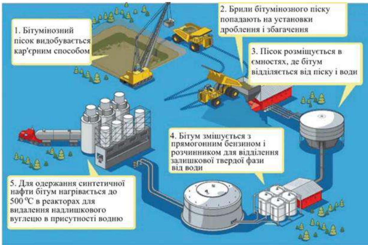
Рисунок 17.3 – Загальна схема ланцюга технологічних блоків при розробці бітумінозних пісків кар'єрним способом
