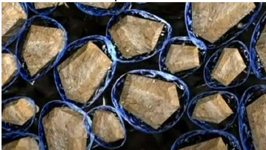
Рисунок 17.4 – Наявність водної плівки на частинках піску уможлиблює його відокремлення від нафтової речовини, яка заповнює міжзерновий простір.
