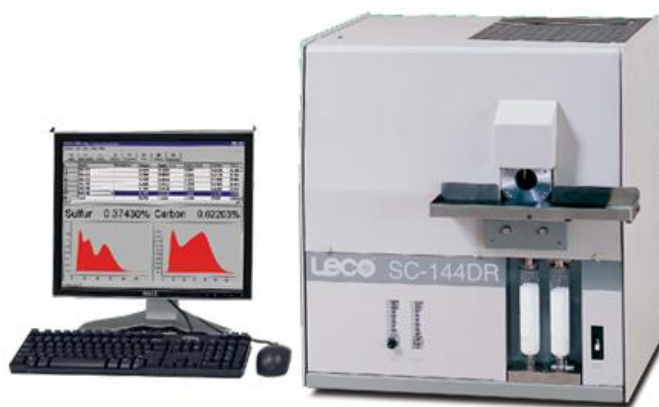
Рис. 2.6 Аналізатор SC-144 DR
