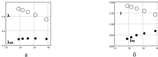
Рис. 1. Залежності коефіцієнту втрат в електропровідному екрані (а) і тривало допустимого струму (б) від товщини ізоляції (для максимальної напруженості електричного поля від 7 кВ/мм до 12 кВ/мм): позначення m стосується середнього кабелю при прокладанні трьох одножильних в площині; практично застосовними для розглянутого кабелю є товщини ізоляції від 20 мм до 25 мм.
