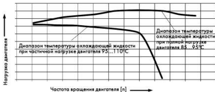
Рис. 3. Значение оптимальной температуры двигателя в зависимости от режима его работы
