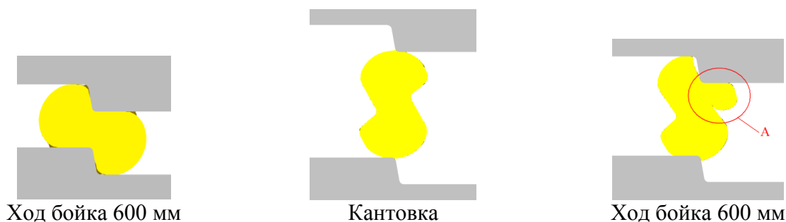
Рис. 4 – Формоизменение поперечного сечения заготовки при ковке ступенчатым бойком с нулевым зазором и высотой уступа 300 мм
