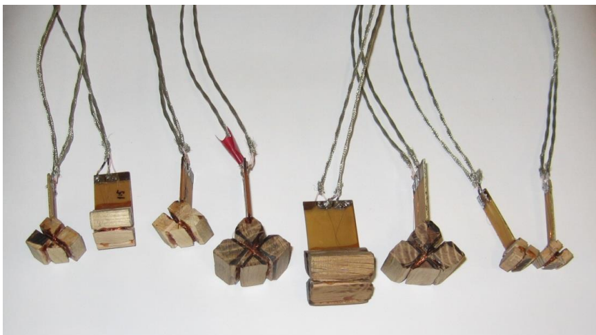
Рис.2. – Модификации компенсированных трансформаторных ВТП для контроля толщины покрытий
