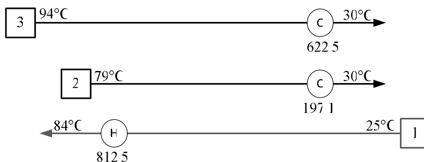
Рис. 1. Сеточная диаграмма технологической схемы ректификации смеси этанол – вода: 1–холодный поток; 2–3 – горячие потоки; Т–температура потока, °С; Q – тепловая нагрузка утилит, кВт.
