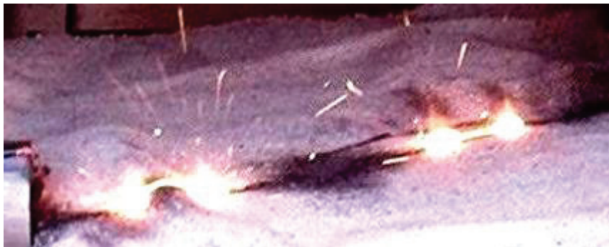
Рисунок 2 – Опытное распределение вдоль электротермически разрушенного оцинкованного стального провода ( r_0 = 0,8 мм; l_0 = 320 мм; \Delta_0 = 5 мкм) «горячих» (макроскопических зон ВЭП провода) и «холодных» продольных гантелеобразных участков, испытывающих воздействие аperiodического импульса аксиального тока временной формы 9 мс/576 мс большой плотности ( \delta_{0m} = 0,37 кА/мм 2 ; n_m = 32 ; \bar{n} = 9 ) [7]
