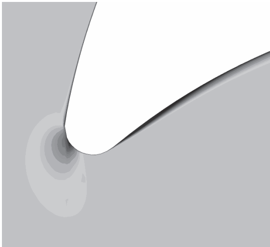
Рис. 2 – Натекание потока на рабочую решетку на среднем радиусе после первого этапа оптимизации
