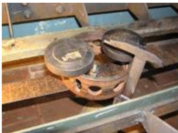
Рис. 6 – Нагружение системы пластин грузилами
