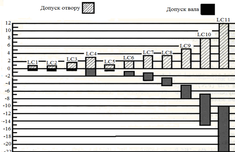
Рис. 5 – Графічне подання розташування перехідних посадок із зазором
