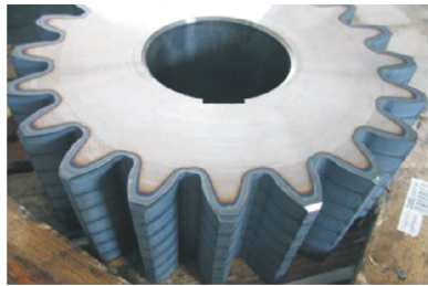
Рисунок 2 – Шестерня с диаметром d=50\text{мм} с поверхностной закалкой посредством лазерного луча [5]
