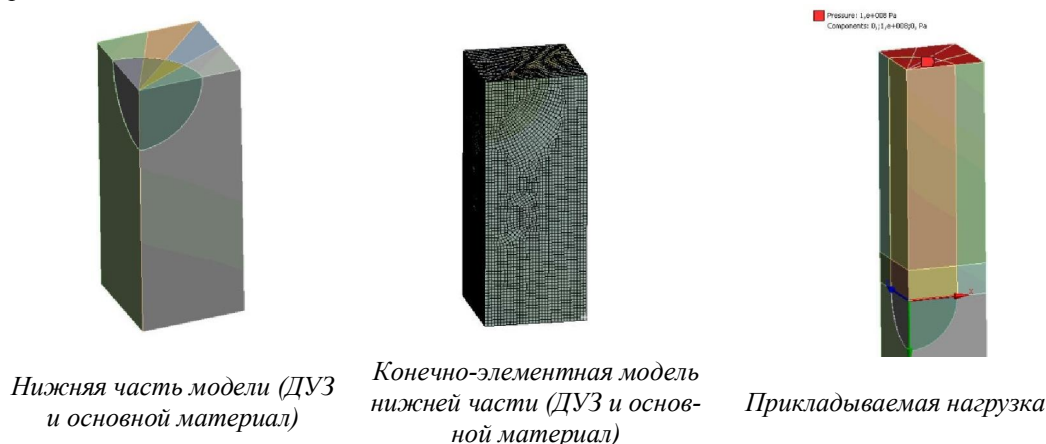
Рис. 3. Геометрическая (нижняя часть модели: ДУЗ и основной материал) и конечно-элементная модели, модель с приложенной нагрузкой
