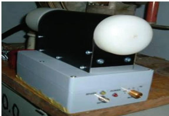
Рисунок 5 – Внешний вид модельного импульсного источника питания на основе импульсного трансформатора
