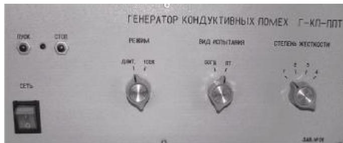
Рисунок 6 – Передняя панель генератора Г-КП-ППТ
