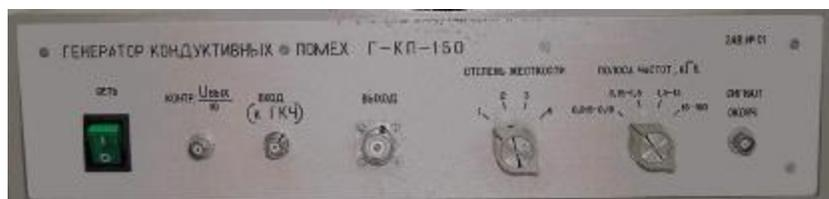
Рисунок 9 – Передняя панель генератора У-КП-150
