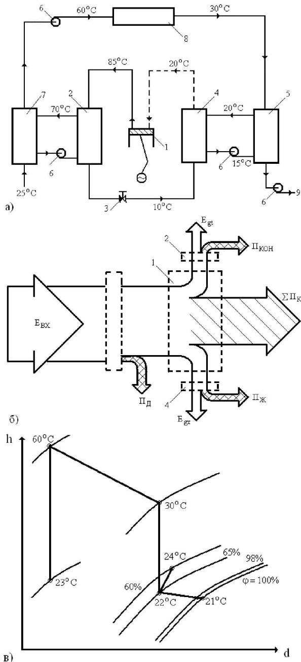
Рис. 4. Комплексное тепло- и хладоснабжение технологически комфорных СКВ на базе ТНУ:
