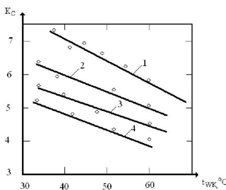
Рис. 6. Зависимость комплексного коэффициента преобразования от температуры нагретой воды  $t_{WK}$  при различных температурах смеси после регулирующего вентиля  $t_{pb}$
