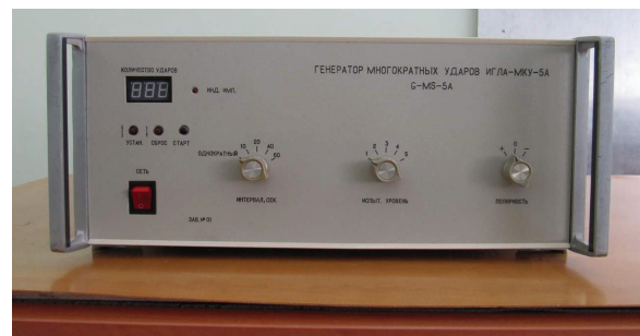
Рисунок 3 – Передняя панель генератора ИГЛА-МКУ-5А
