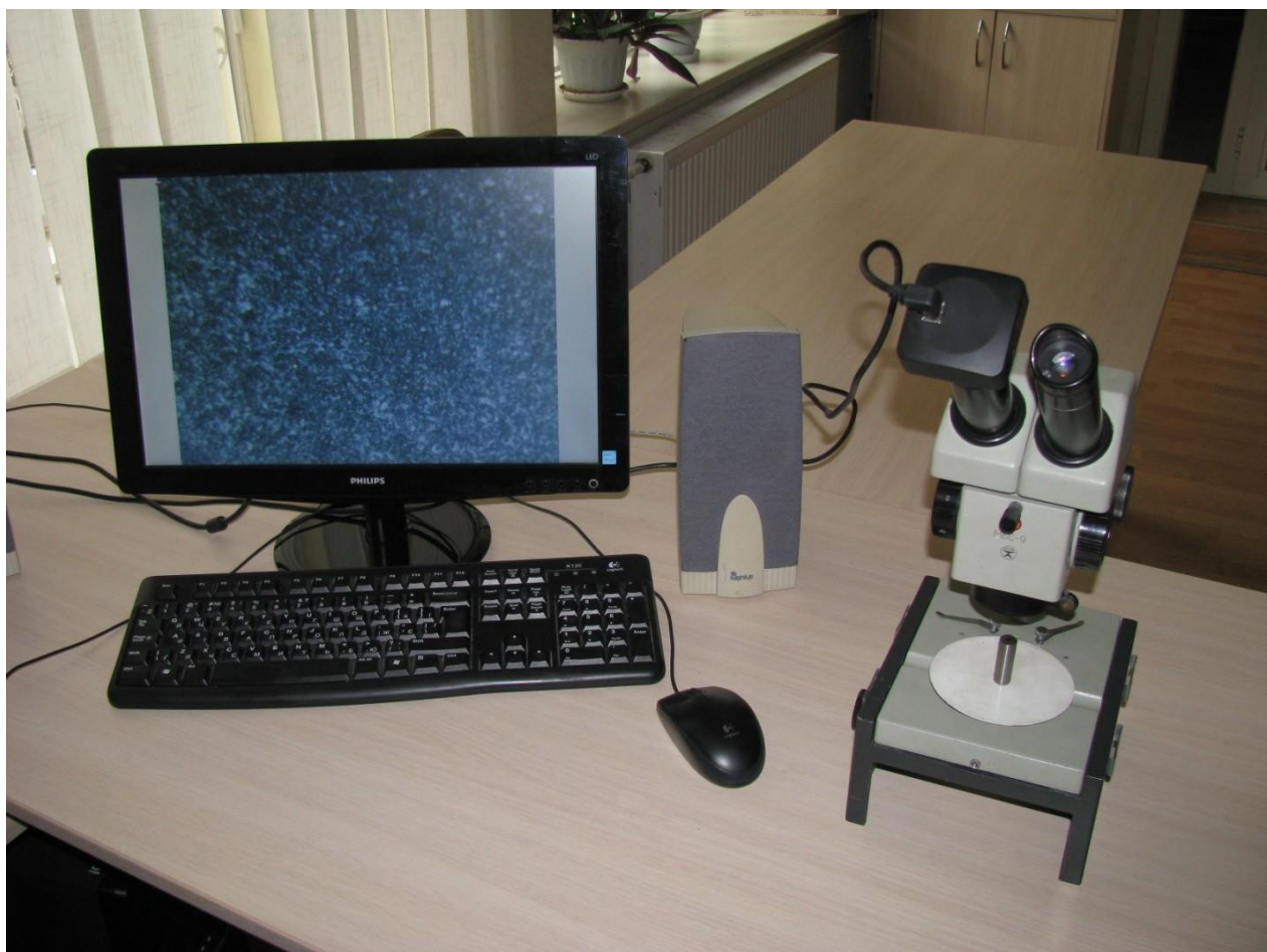
Рисунок 2.4 – Мікроскоп у зборі з цифровою камерою [56]
