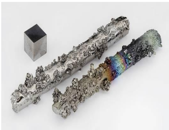
Рисунок 1.3. Кольорові оксидні плівки на вольфрамі
