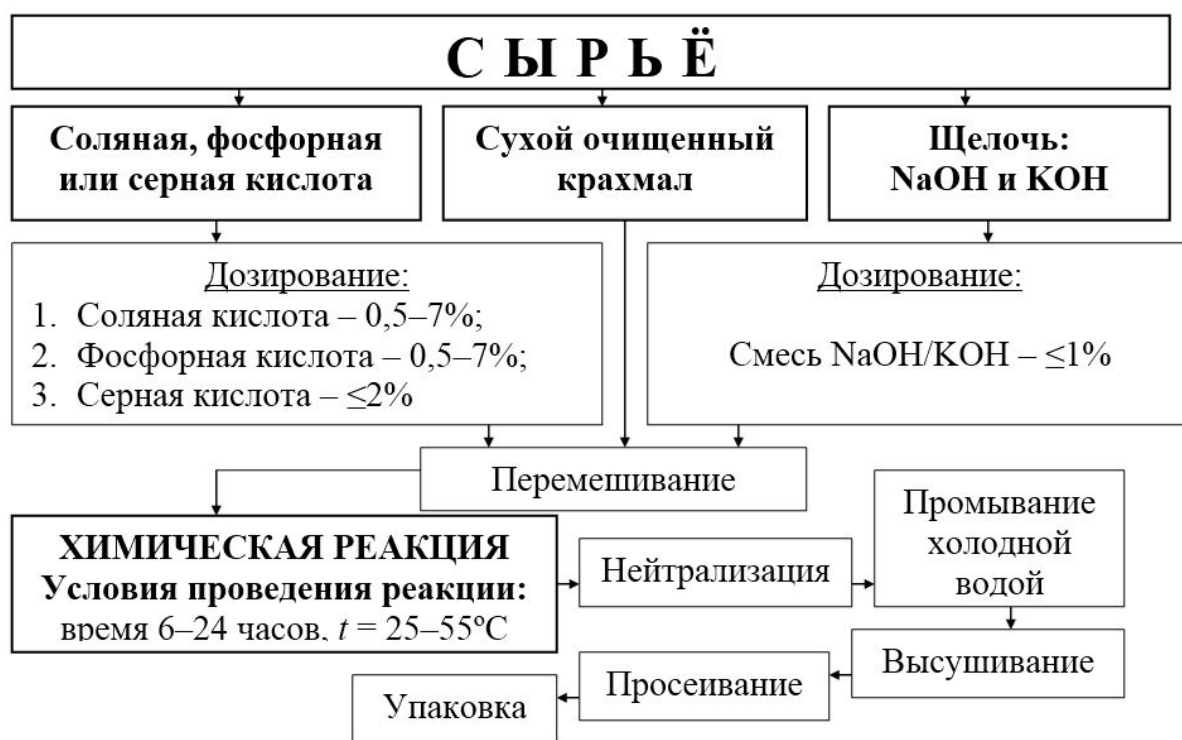
Рис. 3. Технологическая (процесуальная) схема получения кислото- или щелочномодифицированного крахмала
