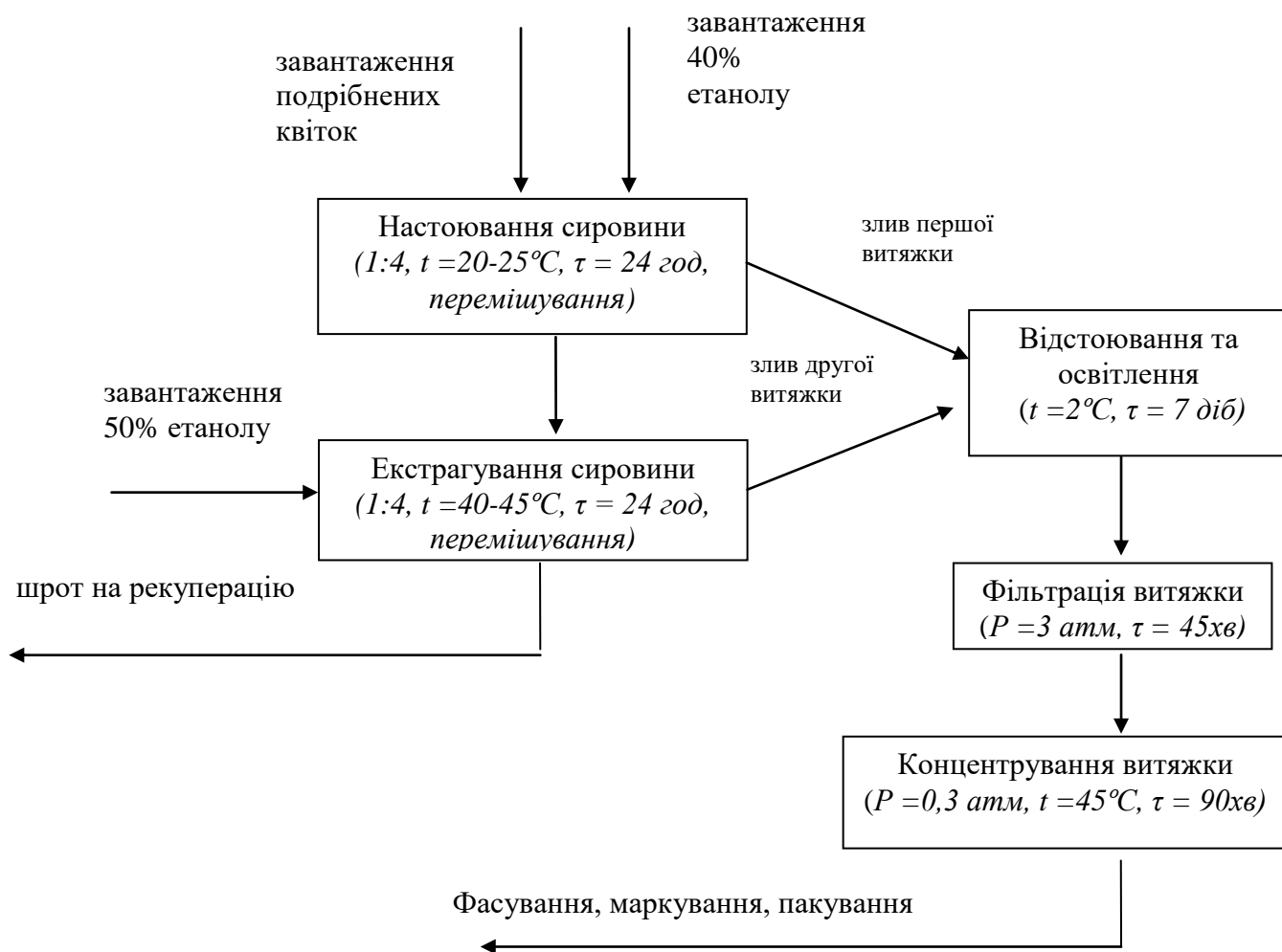
Рис. 2 – Приклад побудування структурної схеми виробництва на прикладі отримання екстракту лютеїну (барвник E161b)
