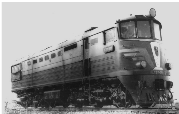
Перший вітчизняний швидкісний тепловоз ТЕ7-001 з пневматичним ресорним підвішуванням
