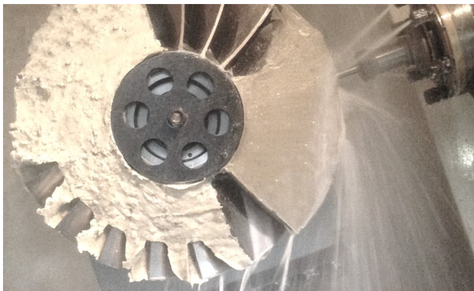
Рисунок 1.10 – Обробка першого рівня пера лопатки моноколеса ГТД на АТ «Мотор Січ» за ручного заповнення технологічним середовищем міжлопатевого каналу та за технологією заливки [28]
