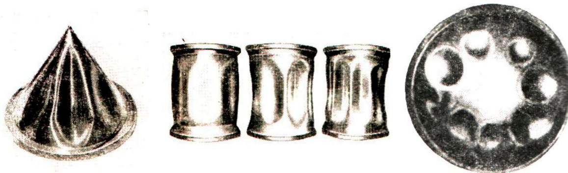
Рис. 2 – Образование гофров на конической, цилиндрической и сферической оболочках*
