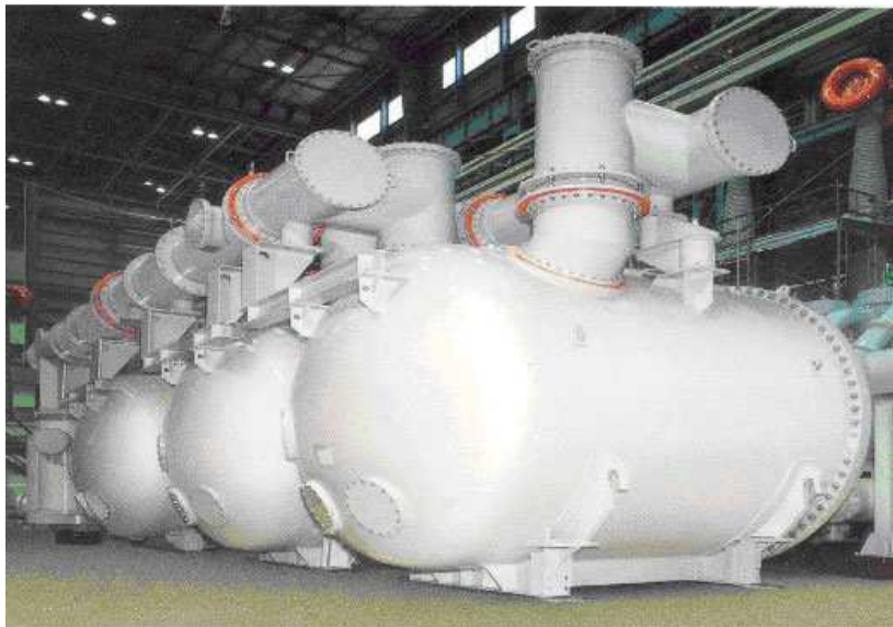
Рис. 6. Полностью герметизированная элегазовая подстанция 275 кВ (Тошиба, Япония)
