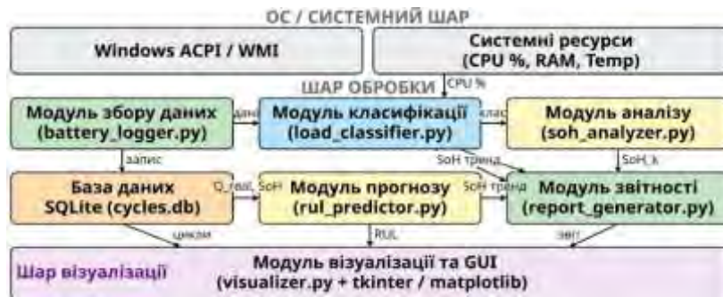
Рис. 2. Архітектура програмного комплексу BattDiag: модулі та потоки даних.
