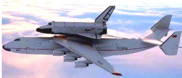
Рис. 14. Самый крупный в мире советский шестимоторный турбореактивный военно-транспортный самолет-гигант типа Ан-225 «Мрия» разработки ОКБ имени О.К. Антонова (1989 г., фото выполнено в процессе транспортировки этим самолетом космического аппарата-челнока «Буран») [2]
