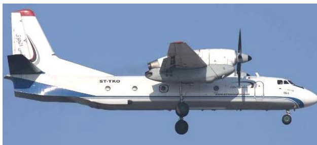
Рис. 10. Легкий двухмоторный турбовинтовой транспортный самолет типа Ан-32 разработки Генерального конструктора О.К. Антонова (1964 г., г. Киев, УССР) [2]
