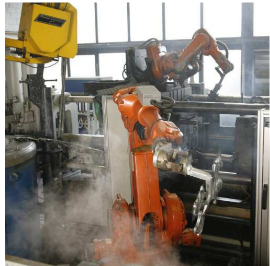
Рисунок 6.71 – Роботизована ділянка для лиття під тиском з двома ПР
