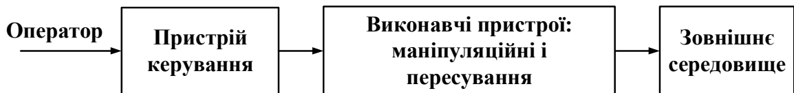
Рисунок 3.34 – Функціональна схема робота
