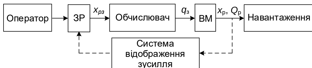
Рисунок 4.42 – Функціональна схема системи керування з задавальною рукояткою
