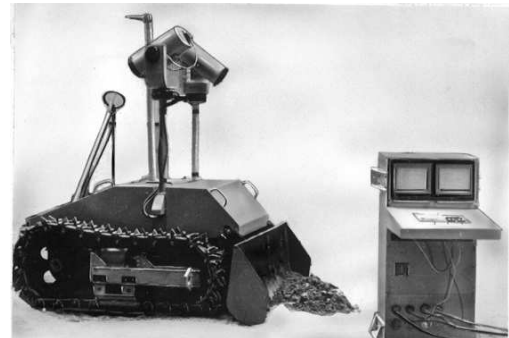
Рисунок 6.107 – Робот з телевізійною камерою та іншими сенсорними пристроями
