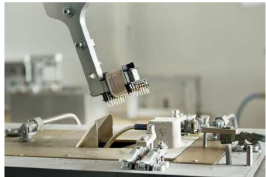
Рисунок 6.94 – Роботизований модуль лудіння виводів компонентів
