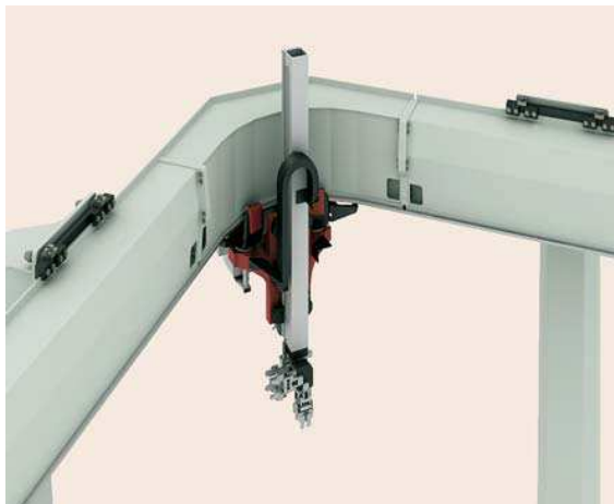
Рисунок 1.17 – Портальний робот в декартовій системі координат
