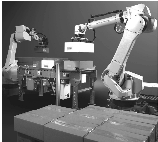
Рисунок 6.82 – Приклад роботизованого пакування в тару
