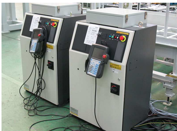
Рисунок 3.36 – Шафи двох ПР FANUC R-2000iB
