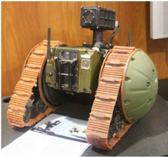
Рисунок 6.117 – Робот-розвідник Viper (Elbit Systems, Ізраїль)
