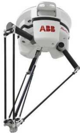
Рисунок 2.19 – Компонівка маніпулятора Flex Picker
