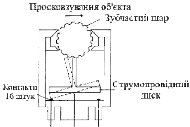
Рисунок 3.31 – Пристрій для визначення величини і напрямку прослизання
