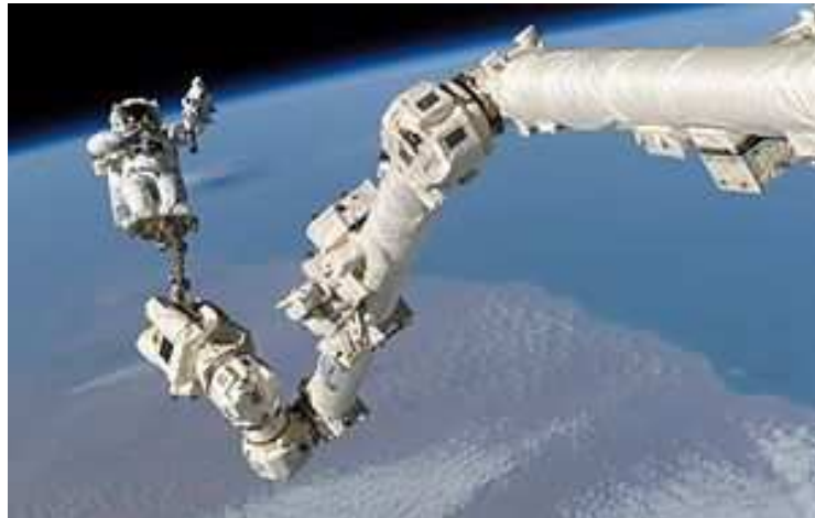
Рисунок 6.111 – Система Canadarm2 при виконанні завдання STS-114 (утримання астронавта Стівена Робінсона)
