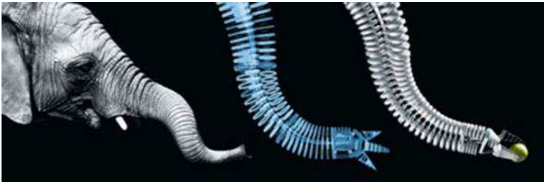
Рисунок 2.22 – Біонічний маніпулятор фірми Festo
