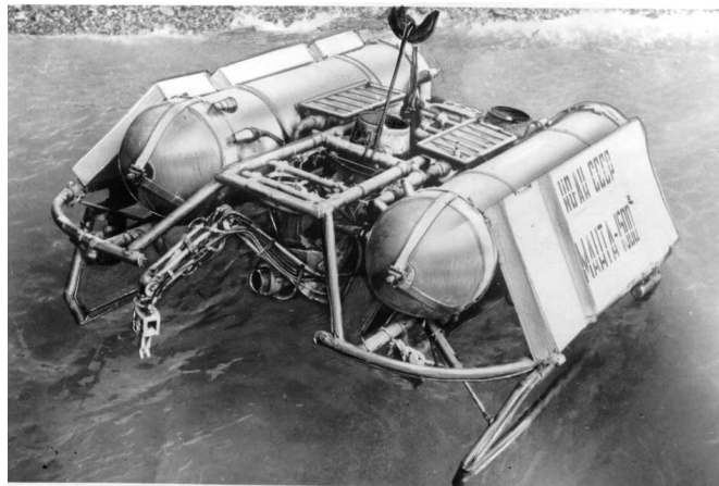
Рисунок 1.21 – Один з перших підводних роботів «Мантa» з системою технічного зору і маніпулятором, керованим від ЕОМ
