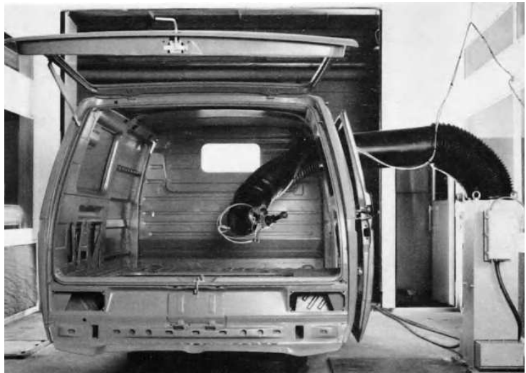
Рисунок 6.41 – Фарбування салону фургона роботом Spine
