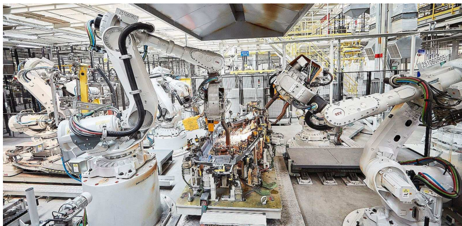
Рисунок 6.32 – Ділянка точкового зварювання кузовів автомобілів роботами ABB
