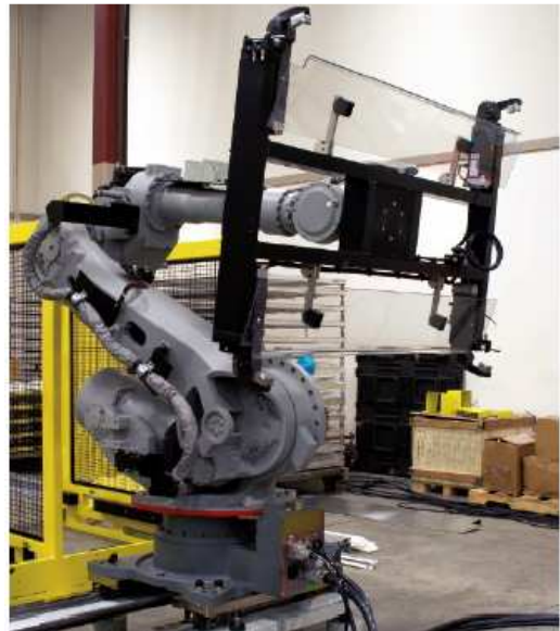
Рисунок 2.49 – Вакуумний захоплювач для перенесення скла
