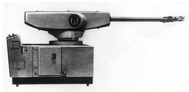
Рисунок 1.9 – Один з перших промислових роботів «Unimate»
