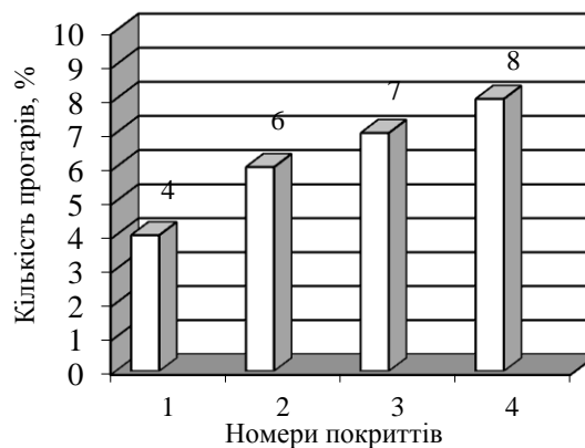
Рис. 2 – Залежність кількості прогарів дослідних покриттів від вмісту у їх складі легкоплавкої емалі № 2 (по табл. 2)
