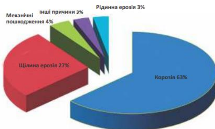
Рис.3- Діаграма причин виникнення негерметичності засувок фонтанної арматури
