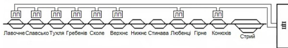
Рис. 1 – Структурна схема локальної мережі зв'язку МСДЦ «Каскад» дільниці Стрий – Лавочне
