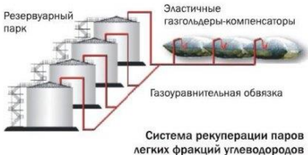
Рисунок 10.6. Резервуарный парк. Пример применения газгольдера для рекуперации паров нефтепродуктов с целью обеспечения пожарной безопасности объектов нефтепродуктообеспечения.
