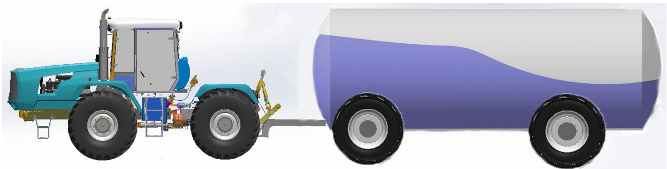
Рис. 1 – Імітація руху рідини в цистерні сільськогосподарського призначення на етапі розгону машинно-тракторного агрегату
