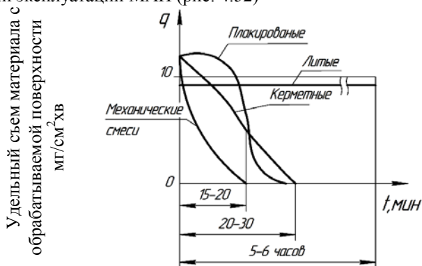
Рисунок 4.51 – Изменение величины удельного сема материала с обрабатываемой поверхности в зависимости от времени обработки
