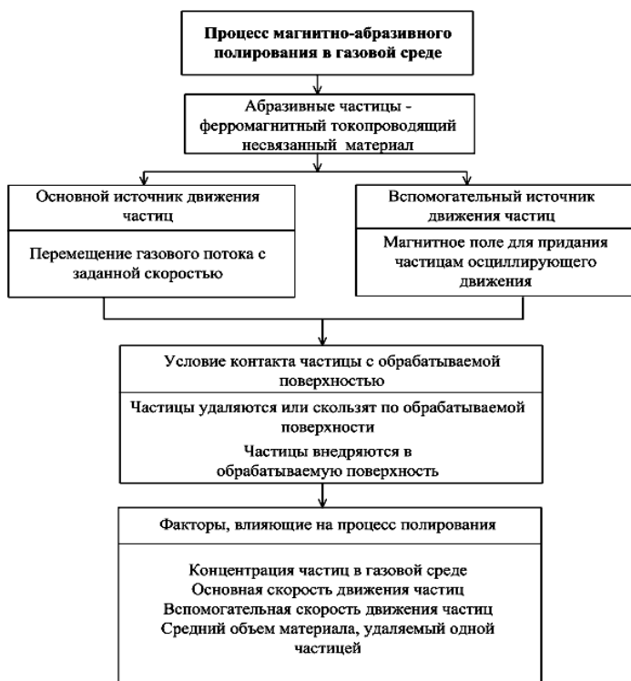
Рисунок 4.71 – Методология интегрированного процесса магнитно-абразивного полирования в газовой среде
