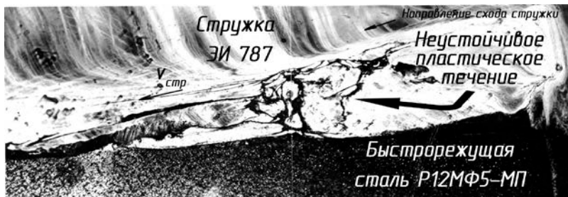
Рисунок 3.81 – Вид контактного взаимодействия стружки и передней поверхности инструмента при точении сплава ЭИ787.
