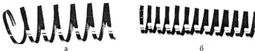
Рисунок 3.66 – Вид стружки при точении стали 45 а – P6M5, б – P6M5+TiN
