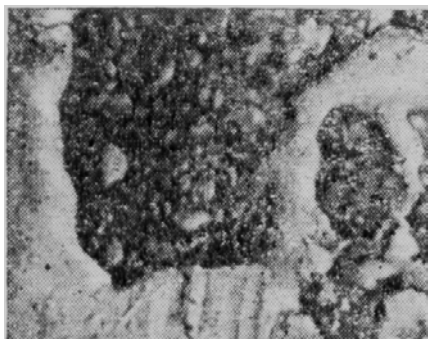
Рисунок 4.94 – Оплавление поверхности сплава Т15К6 в результате действия эрозионного разряда
