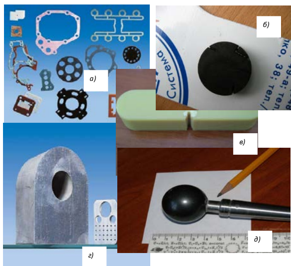
Рисунок 4.126 – Изделия, полученные гидроабразивным способом: листовые детали из уплотнительных материалов (а), изделия из сверхпрочных нитридных (б) и карбидных соединений (д), электроизоляционные материалы (в), титановые и алюминиевые сплавы (г)
