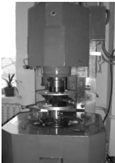
Рисунок 4.44 – Внешний вид станка (а) и рабочей зоны (б) для МАО лопаток ГТД
