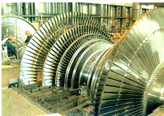
Рисунок 5.12 – Ротор низького тиску турбіни К-220-44-2 АЕС «Ловіса»
