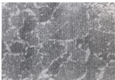
Рисунок 3.14 – Мікроструктура ділянки неповної перекристалізації ЗТВ зварного з'єднання зі сталі 15Х1М1Ф. Ресурс 280 тис. год
