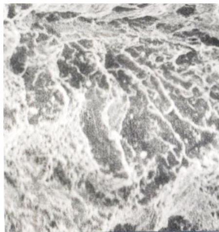
Рисунок 4.6 – Зона зростання тріщини у зварному з'єднанні зі сталі 15Х1М1Ф.
