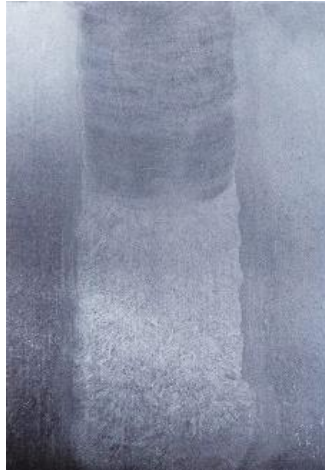
Рисунок 5.15 – Мікроструктура дослідного зразка зварного ротора виготовленого на оптимізованих параметрах режиму, \times 1,1
