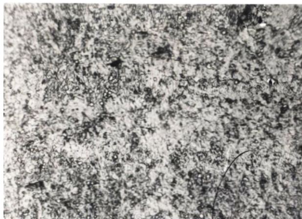
Рисунок 4.4 – Мікроструктура ділянки неповної перекристалізації ЗТВ зварного з'єднання зі сталі 12Х1М1Ф. \times 360 . Ресурс 280 тис. год.
