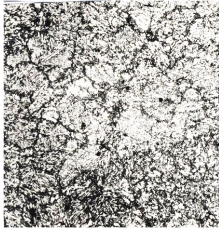
Рисунок 3.23 – Вихідна структура ділянки неповної перекристалізації ЗТВ зварного з'єднання. Темні оторочки по границях зерен \alpha -фази представляють перліт
