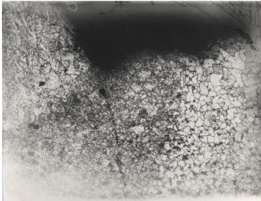
Рисунок 3.1 – Руйнування на ділянці неповної перекристалізації ЗТВ зварного з'єднання паропроводу зі сталі 12Х1МФ. \times 100 . [17].
