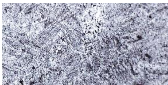
Рисунок 5.19 – Структури основного металу зварного з'єднання зі сталі 25Х2НМФА
