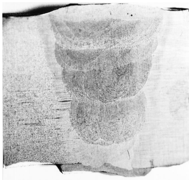
Рисунок 4.2 – Мікроструктура зварного з'єднання паропровода свіжої пари зі сталі 15X1M1Ф. \times 1,0 мкм. [17]
