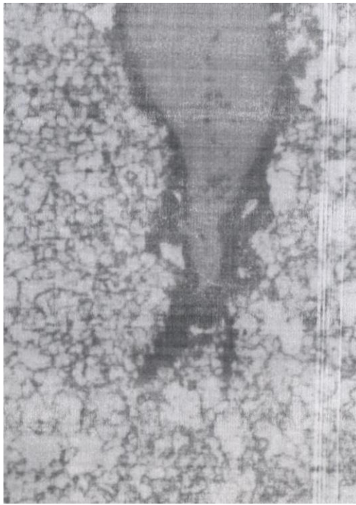
Рисунок 1.4 – Мікропошкоджуваність ділянки неповної перекристалізації ЗТВ зварного з'єднання зі сталі 12Х1МФ паропроводу гострої пари. \times 150 .
