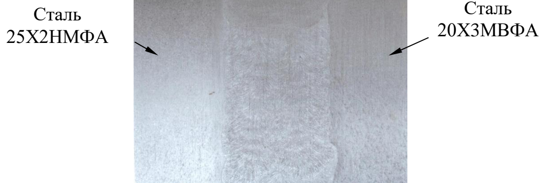
Рисунок 5.5 – Макроструктура комбінованого зварного з'єднання ротора,
