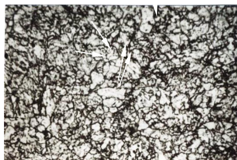
Рисунок 3.10 – Мікроструктура ділянки перегріву ЗТВ зварного з'єднання зі сталі 15X1M1Ф.
