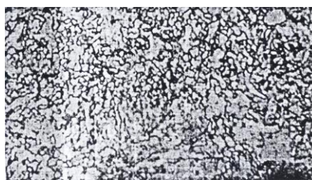
Рисунок 5.7 – Структура металу шва комбінованого зварного з'єднання, див. рис. 5.6. Зразок кореневої зони 1. \times 400
