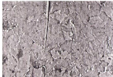
Рисунок 3.5 – Тріщина повзучості в металі шва (сплав 10ХМФ) зварного з'єднання зі сталі 15Х1М1Ф. \times 20 мкм. Ресурс 190 тис. год
