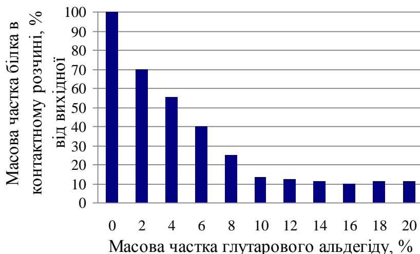
Рис. 1. Залежність масової частки білка в контактному розчині від масової частки конденсуючого агента - глутарового альдегіду.
