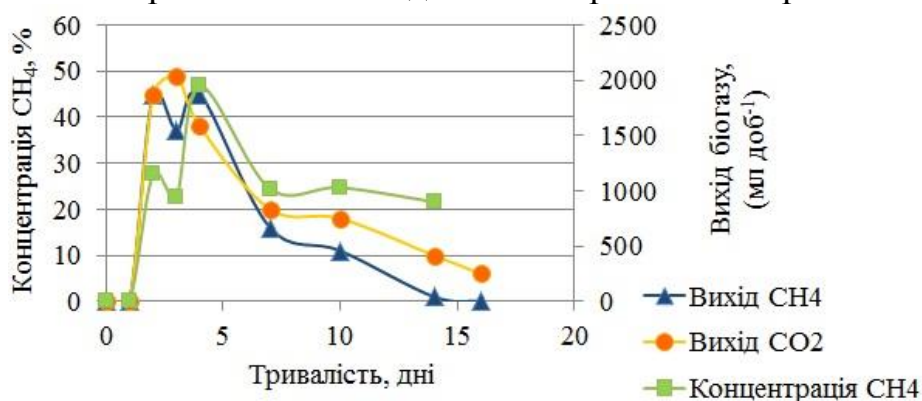
Рис. 1. – Вихід метану з UASB-реактора при регулюванні значення рН фільтрату із реакторів
