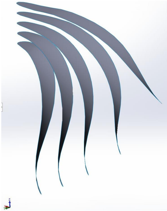
Рисунок 2.2 – Розрахункові профілі лопаті робочого колеса радіально-осьової гідротурбіни
